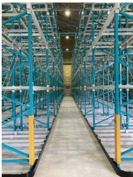
倉庫2棟ともにラックを配置し、最大1棟1,275パレット、2棟合計で2,550パレットの保管が可能
